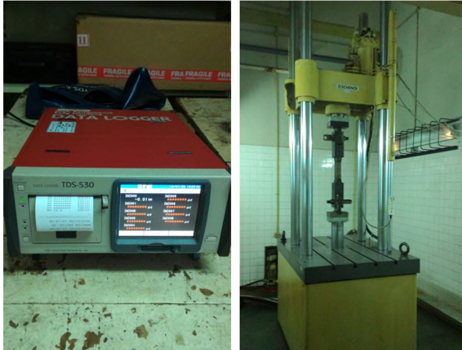
Gambar 2-3. Mesin uji Servohidrolik 250 KN dan Data logger
