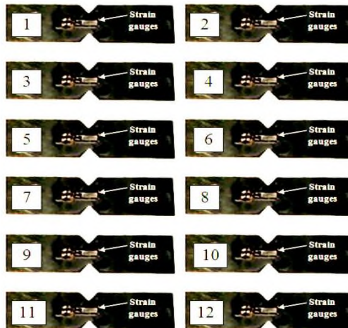
Gambar 2-2. Bentuk benda uji yang diteliti dengan jumlah masing-masing 12 pcs untuk setiap bentuk susunan arah serat dan letak strain gauges pada takikan.
