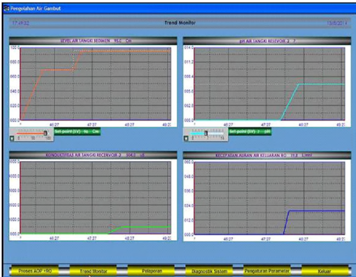
Gambar 4-10. Layar HMI yang menampilkan hasil pengukuran level, pH, konduktivitas dan debit aliran
