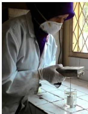
Gambar 3-2. Pengukuran viskositas prepolimer dengan viskometer rion VT 04F Spindle 01
